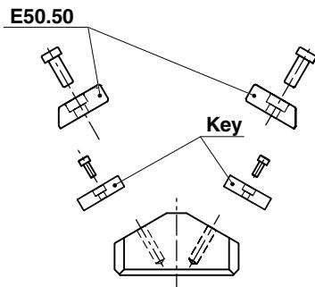
**SINTERED STEEL WEAR PLATE**
