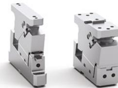
**④** **DLD** die mounted cam are best suited for medium/light drilling. They are not suitable for flanging. **Zwei Modelle mit Arbeitsspannweite von 40 bis 79 kN, Nutzbreite von 52 bis 90 mm, Arbeitswinkel 0° bis 20° (in 5° Schritten) bei Breite 52, Arbeitswinkel von 0° bis 15° (in 5° Schritten) bei Breite 90.** Rückzug nur mit Schraubendruckfeder möglich.
