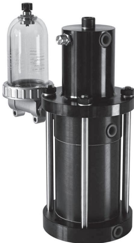
HEB - Tauchkolben - Druckübersetzer mit oben angeordnetem Ölraum, zur Umsetzung eines maximalen Luftdruckes von 8 bar in vielfach höheren Öldruck, das wirtschaftliche luft-hydraulische Antriebsaggregat für kurze bis mittlere Zylinderhöhe, bei hohen Kolbenkräften und exakten Vorschubbewegungen.
